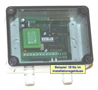
Der stationäre Sender IS16s ist ein Derivat des Industriesenders IS16, welcher für eine stationäre Installation optimiert ist.
